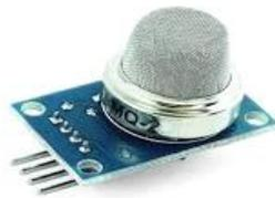
**Figure 22 : Gaz Sensor MQ2.**
