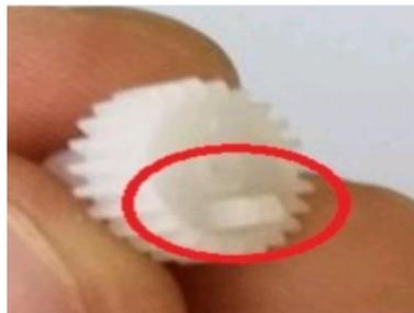
Couper la patte qui se détache de l'engrenage. Remplacement du potentiomètre par les deux résistances.
