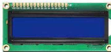
Figure 16 : Module LCD 1602 A (V2.0).
