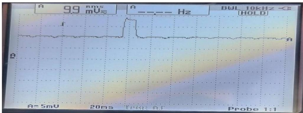
Fig 4.5 Photo du graphe de la consommation électrique du capteur humidité du Sol
