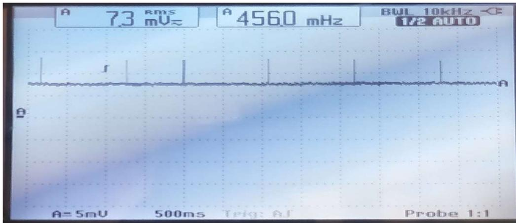
Fig 4.4 Photo du graphe de la consommation électrique DHT11
