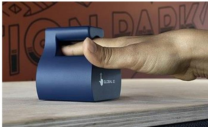
**Figure II.2 :** Scanner d'empreinte veineuse du doigt.
