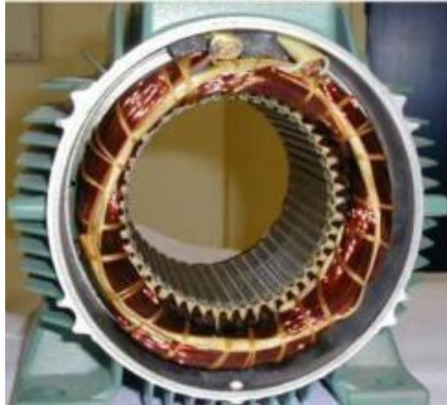
Figure I. 2-Stator d'un moteur asynchrone
