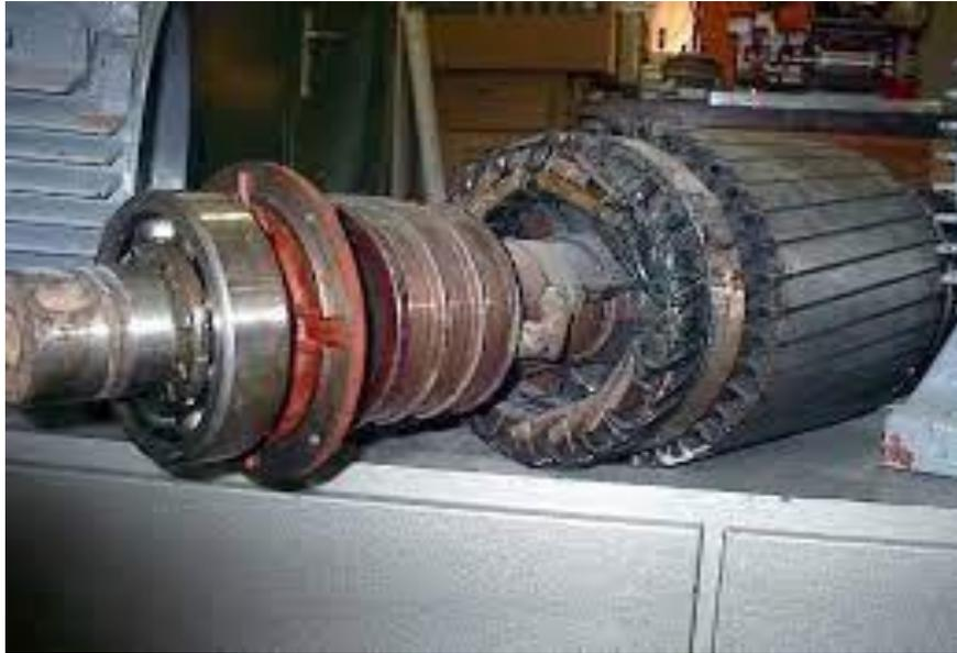
**Figure I. 3-Rotor bobiné d'un MAS**
