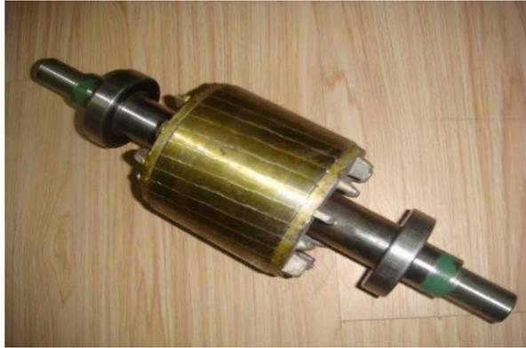
**Figure I. 6-**Rotor à cage
