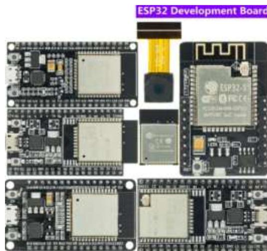
**Figure III.5 Quelques variantes de carte de développement ESP32**
