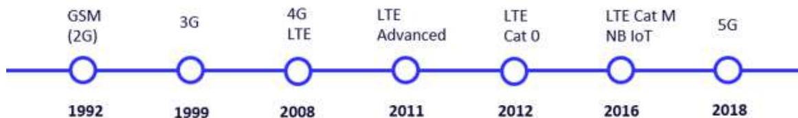
**Figure II.3 -normes 3GPP par réseau. Source : 3GPP**
