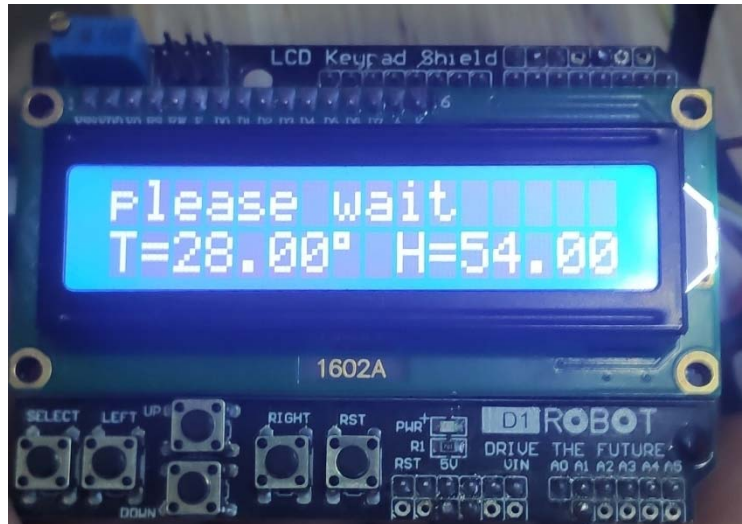
Figure 22 : affichage de la température et l'humidité
