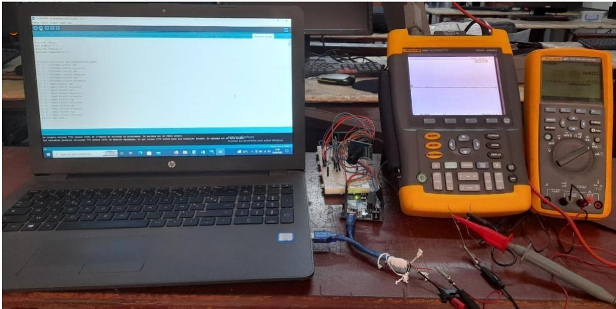
**Figure 35 : Photographie du montage pour la mesure de la consommation énergétique**
