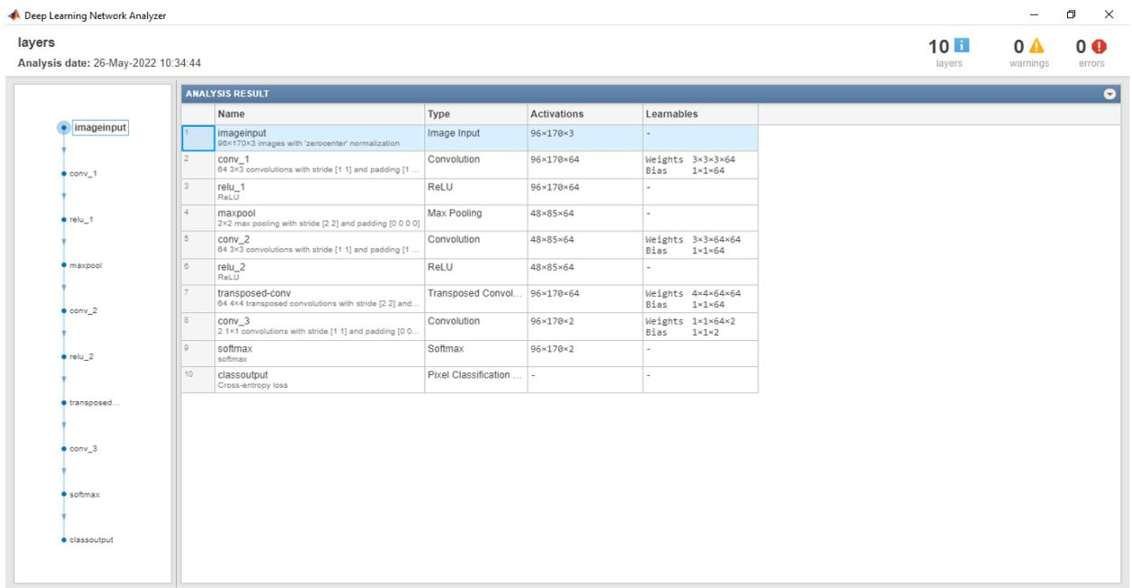
Figure (3.10) : Architecture du Modèle2 encodeur –décodeur U-net2
