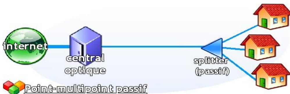
*Figure (I.6) : Architecture de la liaison point multipoint passif*
