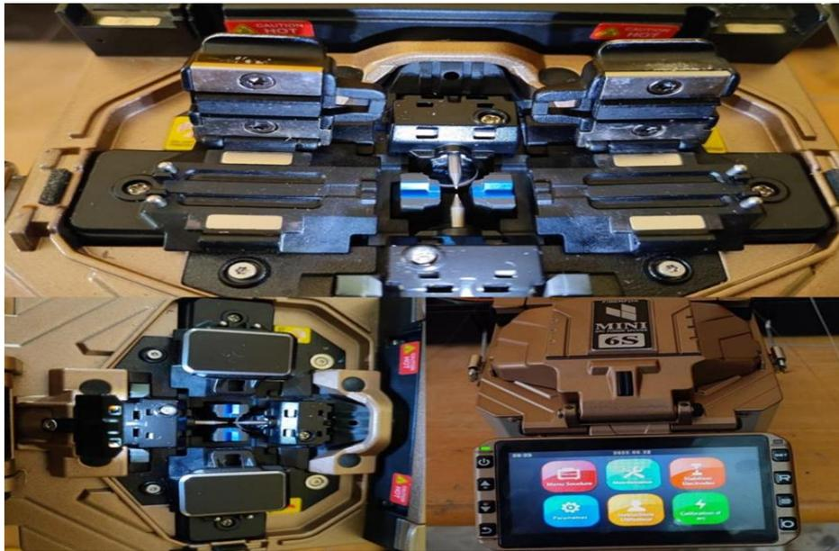
*Figure (II.8) : Appareil de soudure (Fusionneuse)*
