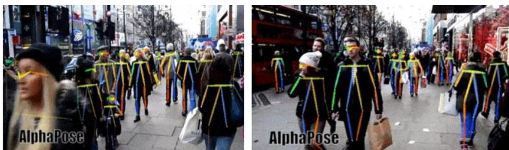
Figure 16 : Estimation de pose multi-personnes avec AlphaPose.[35]
