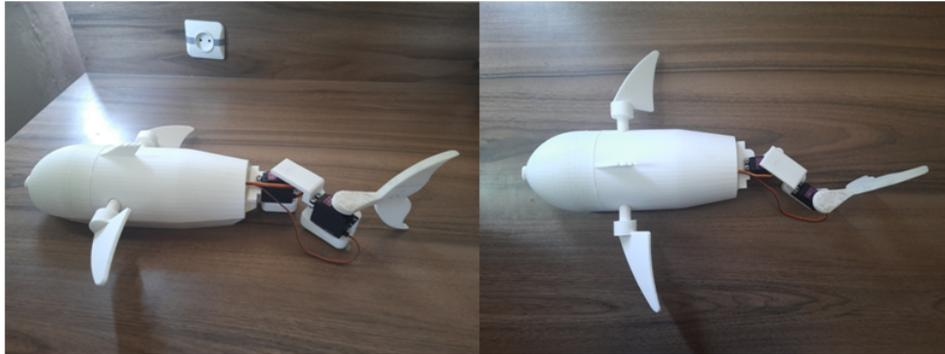
FIGURE 3.1 – Le prototype du robot poisson.
