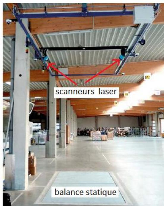
Fig1.1 : Système de mesure de poids et volume [1]
