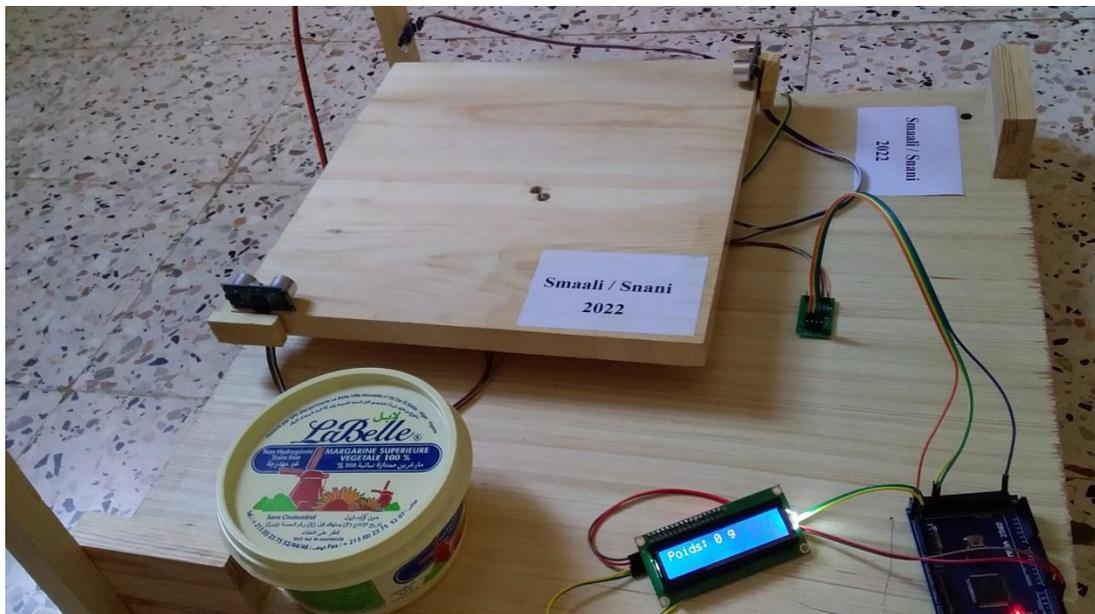
Fig 3.14.a) Calibrage du capteur de poids
