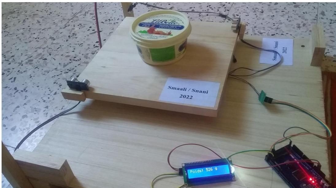
Fig 3.14.b) Mesure du poids d'un produit
