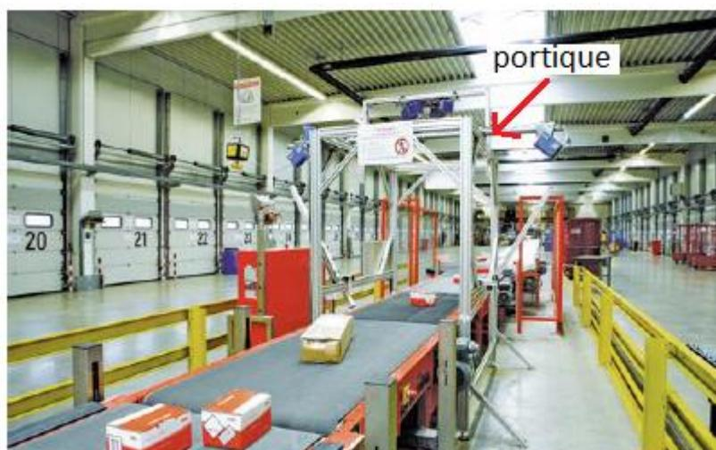
Fig 1.3 Mesure volumétrique par laser
