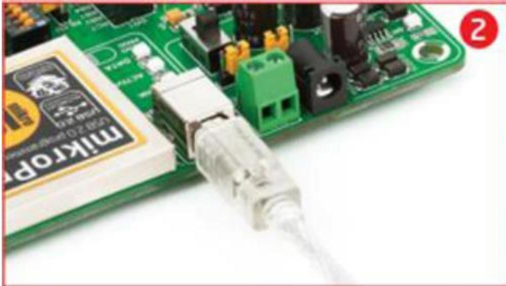
Figure IV.2 connexion du câble USB
