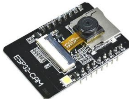
Figure II.5: Carte ESP32 avec caméra 2PM et carte SD [21].
