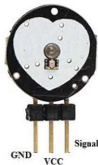
Figure IV.2: Capteur de pouls [37].
