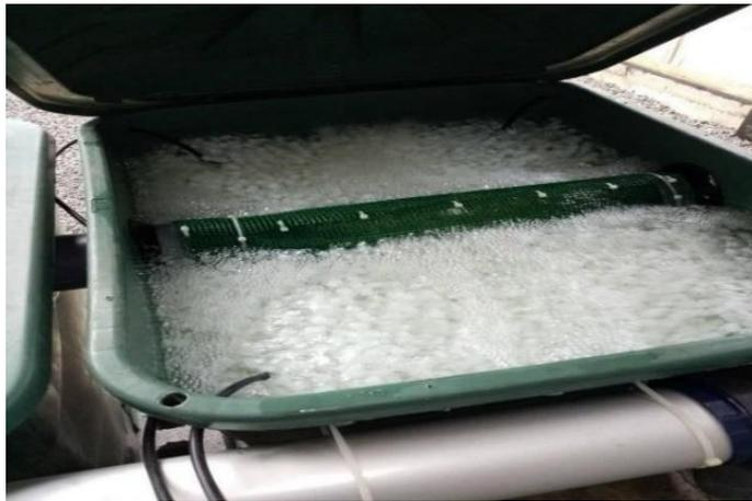
**Figure 11:** Exemple de filtre biologique sur lit fluidisé DIY réalisé par Sébastien Ladrage – Aquaponie Réunion
