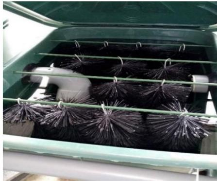
**Figure 9:** Exemple de filtre mécanique à brosses DIY réalisé par Sébastien Ladrage – Aquaponie Réunion
