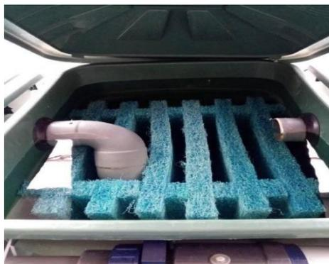
**Figure 10:** Exemple de filtre mécanique à mousses DIY réalisé par Sébastien Ladrage – Aquaponie Réunion
