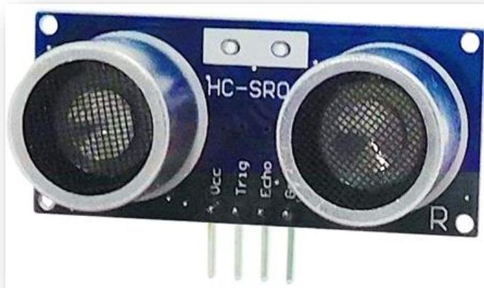
**Figure 9 :** Capteur ultrason
