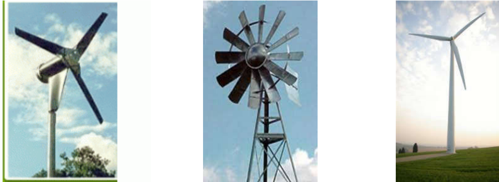
Figure I- 9: Éoliennes à axe horizontal.
