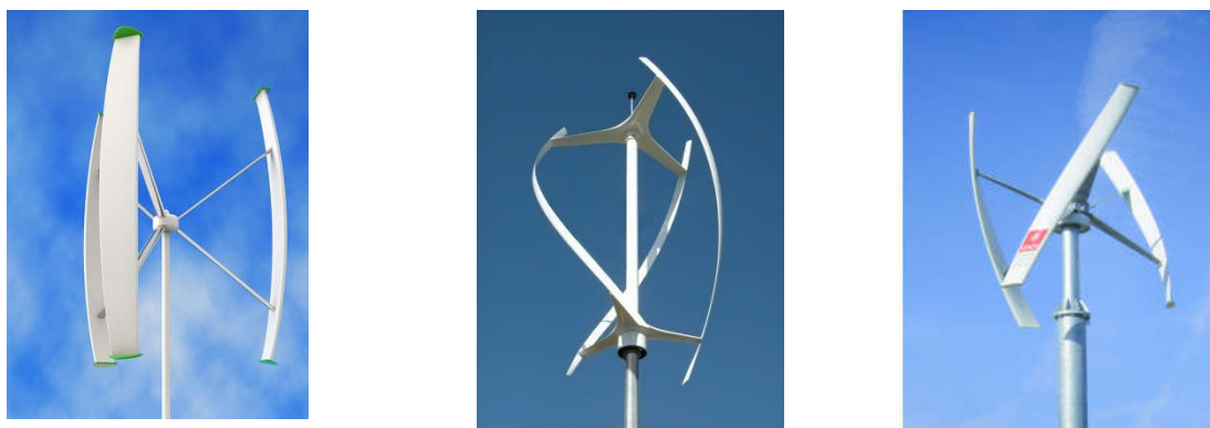
Figure I- 11: Éoliennes à axe vertical.
