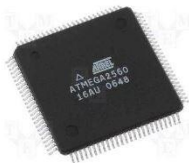
Figure 24 Carte microcontrôleur ATmega2560
