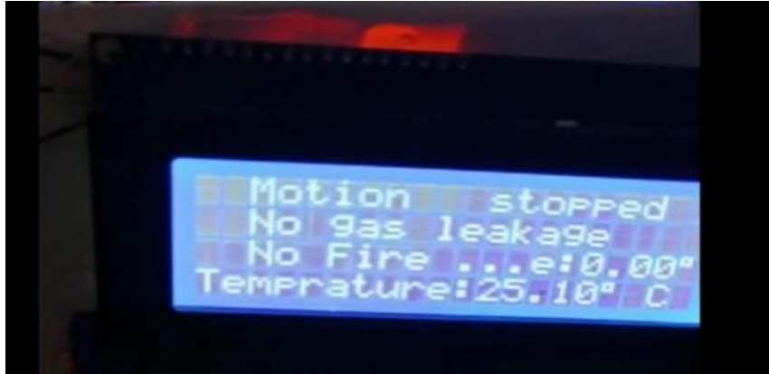
Figure 66 Pas de flamme détecté
