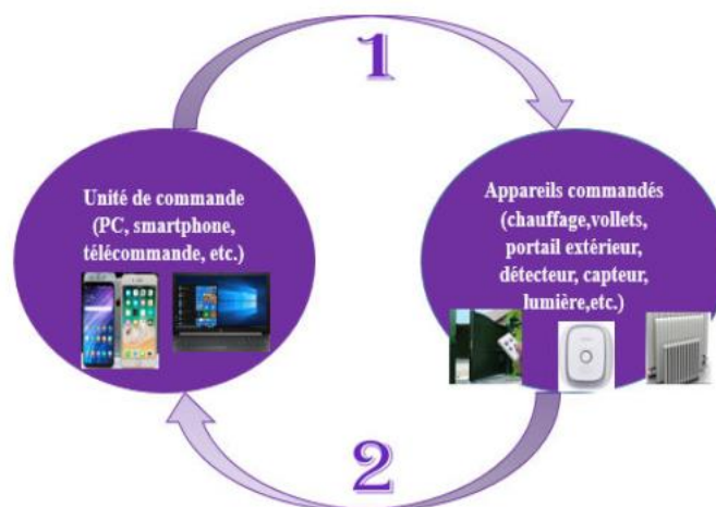
Figure 2 Circulation d'information en domotique
