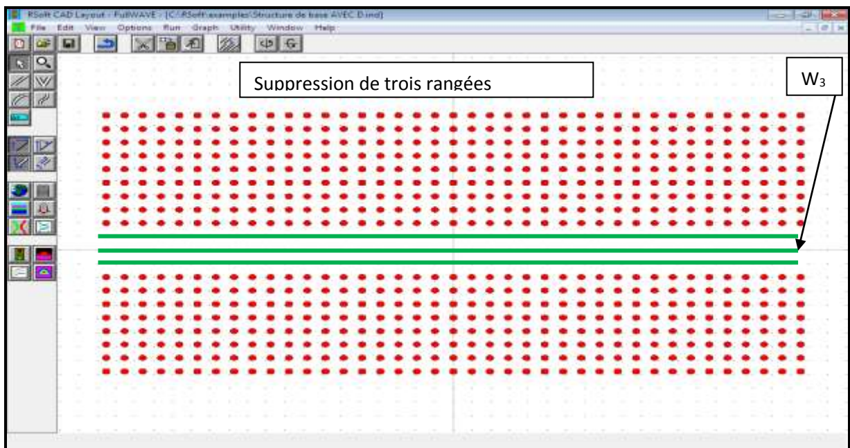
Figure (III.14): Structure d'un guide d'onde multimode : W_3
