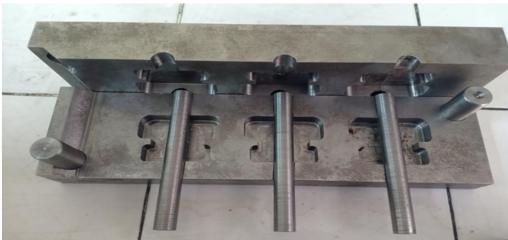
Figure III.25. Le moule complet après l'usinage
