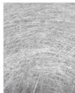
Figure 1.11 : tissu et fibres disposées de façon aléatoire
