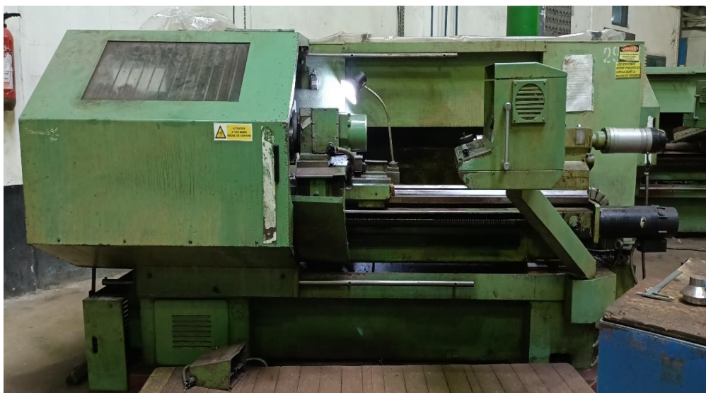
Figure III-4 Tour à commande numérique 16K20, BOSCH CNV ALPHA2
