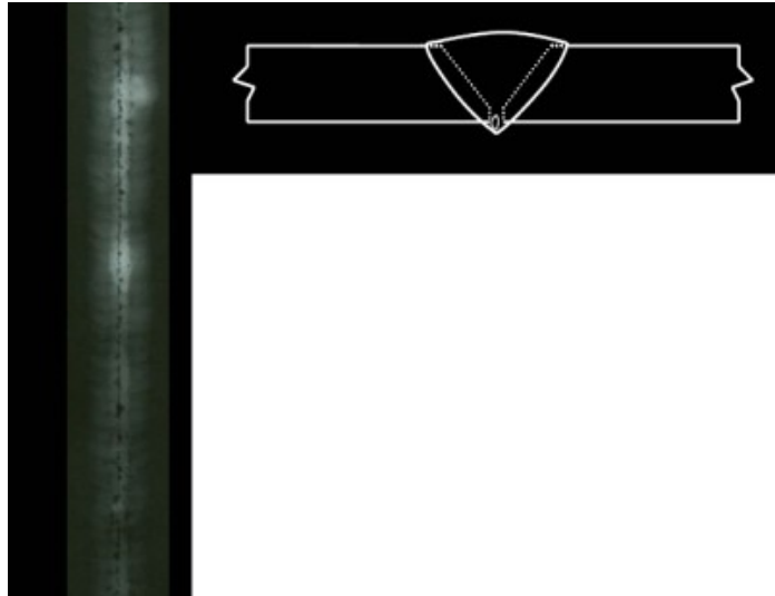
Figure 76 : L'image radiographique porosité ou soufflure enlignée la racine du joint.
