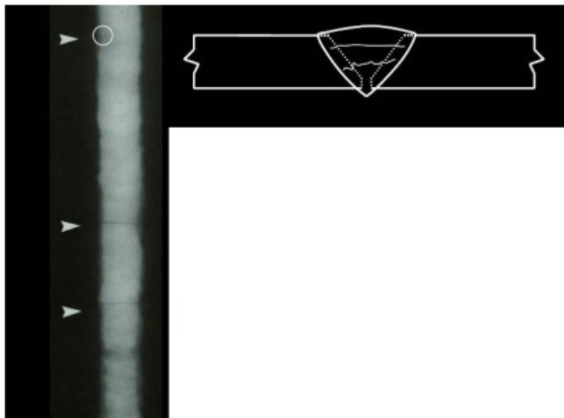
Figure 77 : L'image radiographique fissure transversale.
