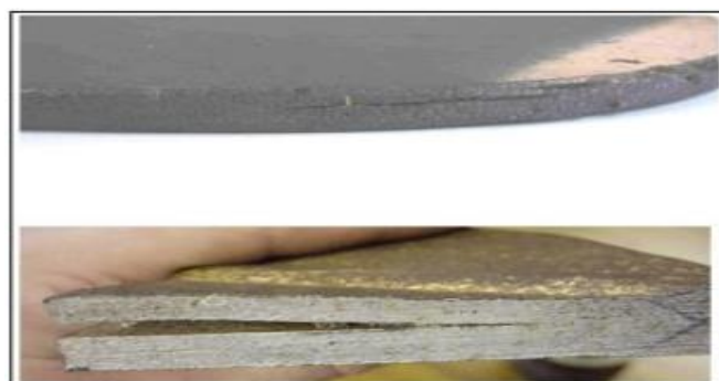
Figure 52 : Doublure de laminage.
