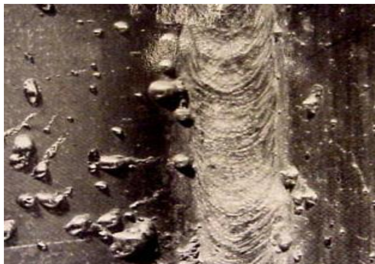
Figure 45 : Projections sur le métal de base.
