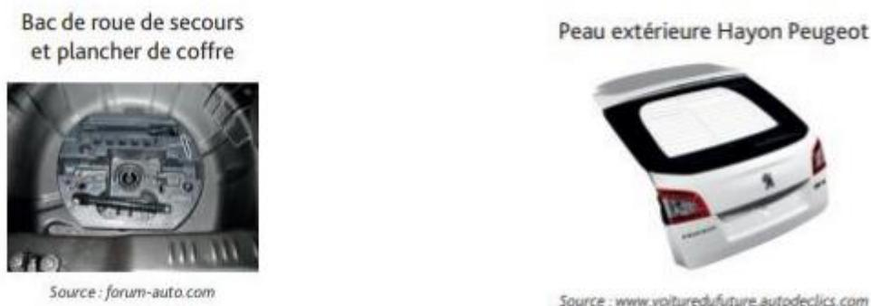
**Figure IV-1:** Pièces de voiture en matériaux composites
