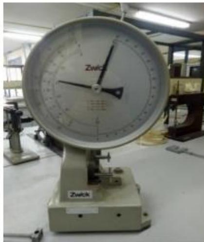
**Figure II-9: Mouton pendule ( machine d'essai de résilience)**
