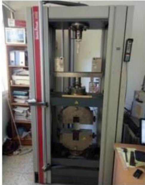
Figure III-1: Machine de traction de marque zwick/Roell
