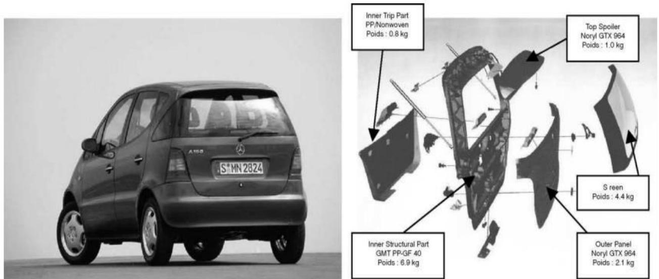
**Figure IV-3:** Vue du hayon de la Mercedes classe A et éclaté de la pièce.
