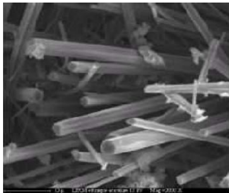
Figure I.22. Observation au Microscopie Electronique à Balayage d'ettringite.
