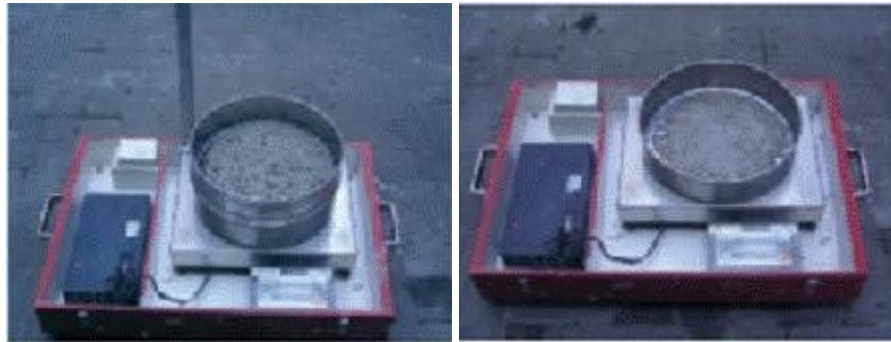
Figure III.5. Essai de stabilité au tamis
