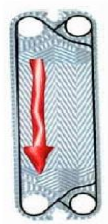
Figure II.5.1: La circulation des fluides est latérale.
