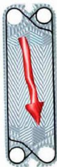
Figure II.5.2: La circulation des fluides est diagonale.
