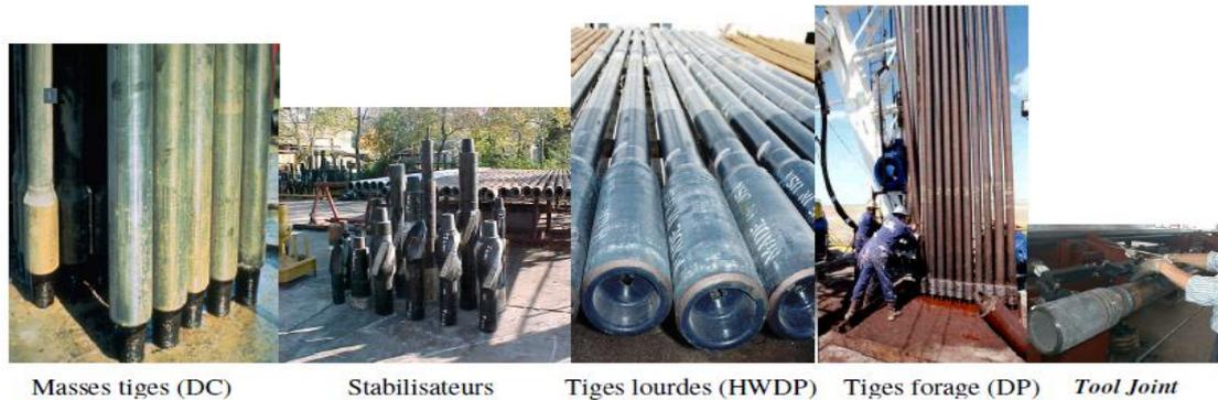
Figure I-12 : Quelques éléments de la garniture de forage [26]
