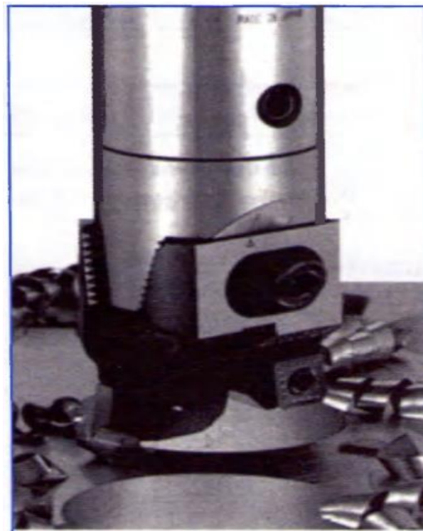
Figure .I.37. Exemple d'alésage à la barre (Balance-Cut) à 2 plaquettes carbure.
