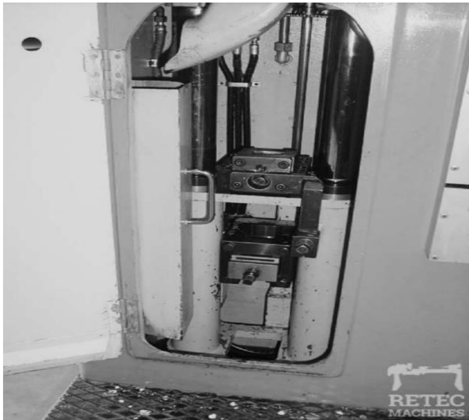
Figure .I.43. Machines à brocher vertical.[23]
