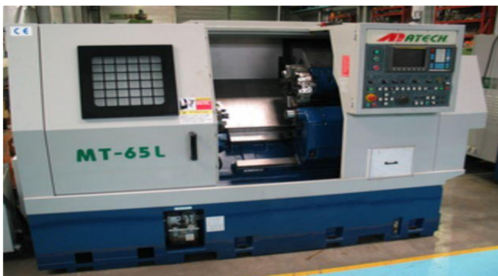
Figure .I.29. Tour à commande numérique.[18]
