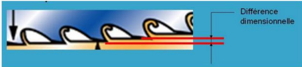
Figure .I.41. Représentation des dents de la broche.
