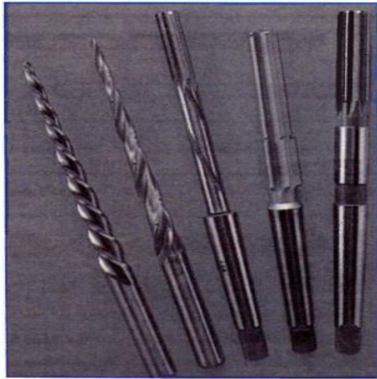
Figure .I.30. Alésoirs Monoblocs.
