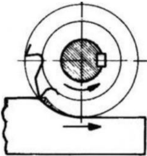
Figure I.19. Fraisage en bout en avalant.
