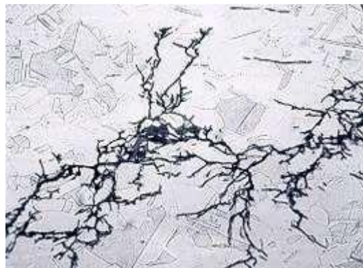
Figure 0-25 : La corrosion sous contrainte
