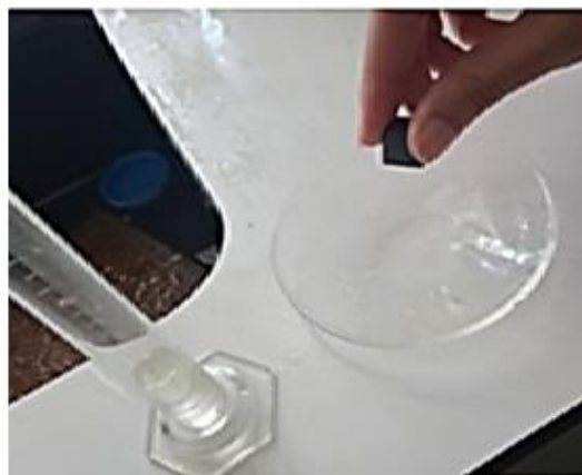
Attaque chimique Nital 3%
