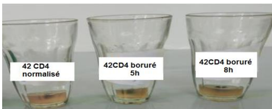
Figure II-12 : Immersion des échantillons dans la solution de H_2SO_4 à 10 %
