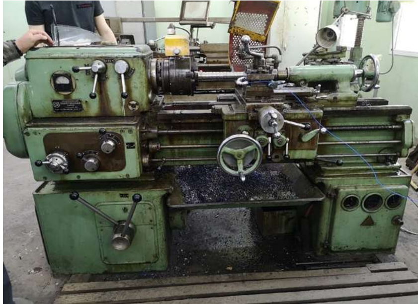
Figure 3.5 : Tour universel modèle AI616 fabriqué en URSS
