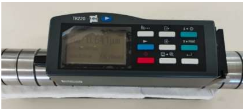
(Figure 3.7) Rugosimètre modèle, TR220.
