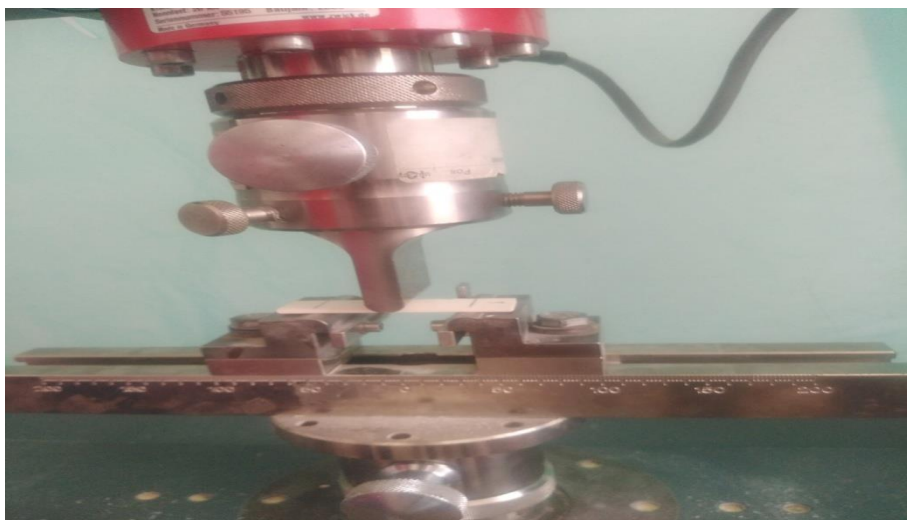
Figure 4-4 : Principe d'essai de flexion 3 points
