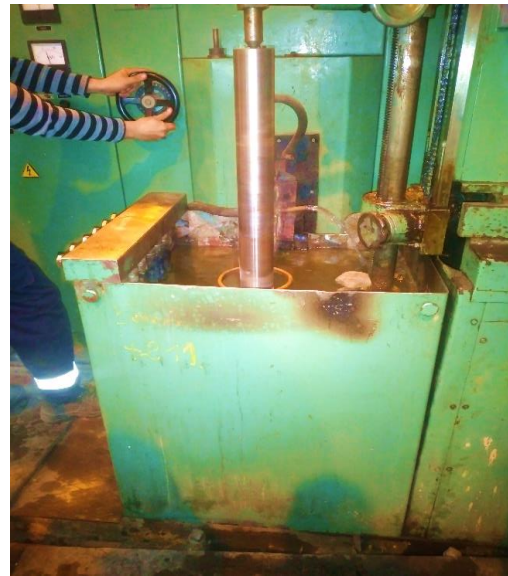
Figure : II.8. Traitement thermique de la pièce
