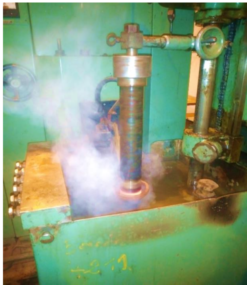
Figure : II.8. Traitement thermique de la pièce
