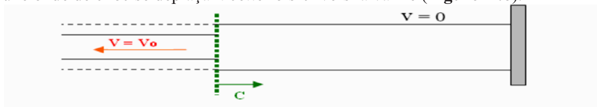
Figure II.6 : Phase 2 : Descente de l'onde après réflexion totale au réservoir (Le diamètre de la conduite reprend sa valeur initiale).
