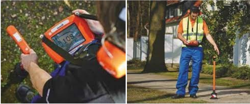
Figure I.2 : Appareil d'auscultation typiques se trouvent les tiges d'écoute à gauche et les microphones au sol à droite.
