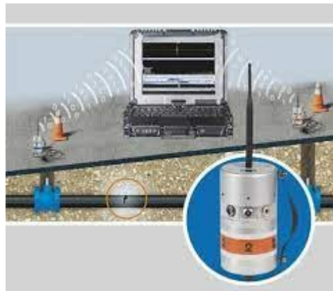
Figure I.3 : Corrélateur acoustique méthode de mesure numérique peuvent être visualisé sous forme d'image.
