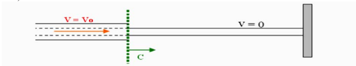
Figure II.8 : Phase 4 : Redescente de l'onde de dépression.
