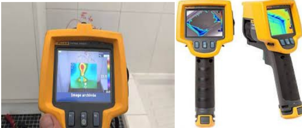
Figure I.4 : Caméra thermique permettre de visualiser et localiser la fuite.
