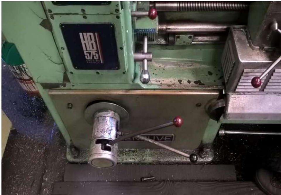
Figure 17: Tour universel à charioter et à fileter CAZENEUVE HB575
