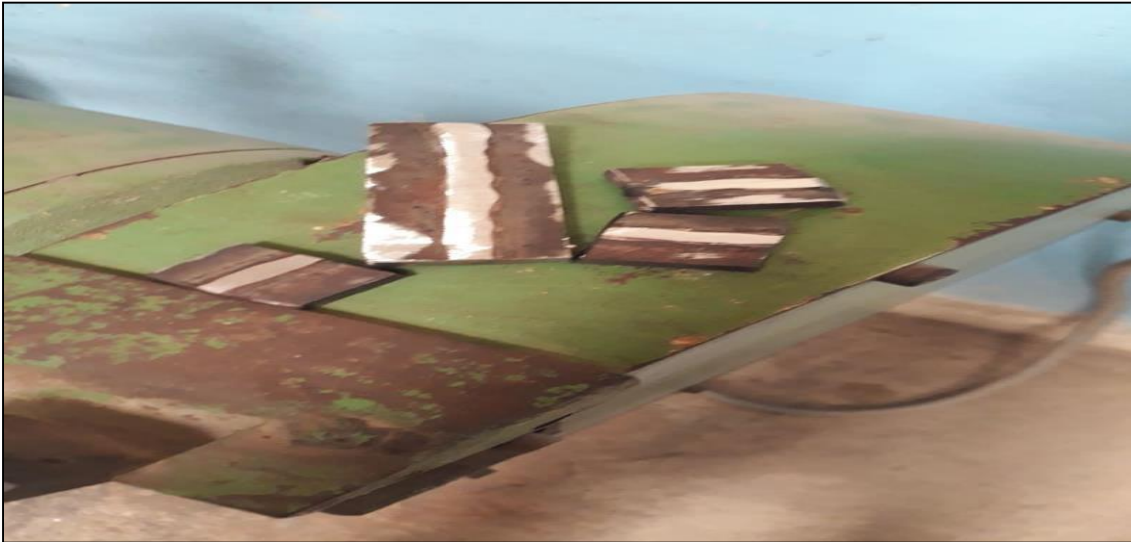
Figure IV.1: Découpage de plaques soudées
