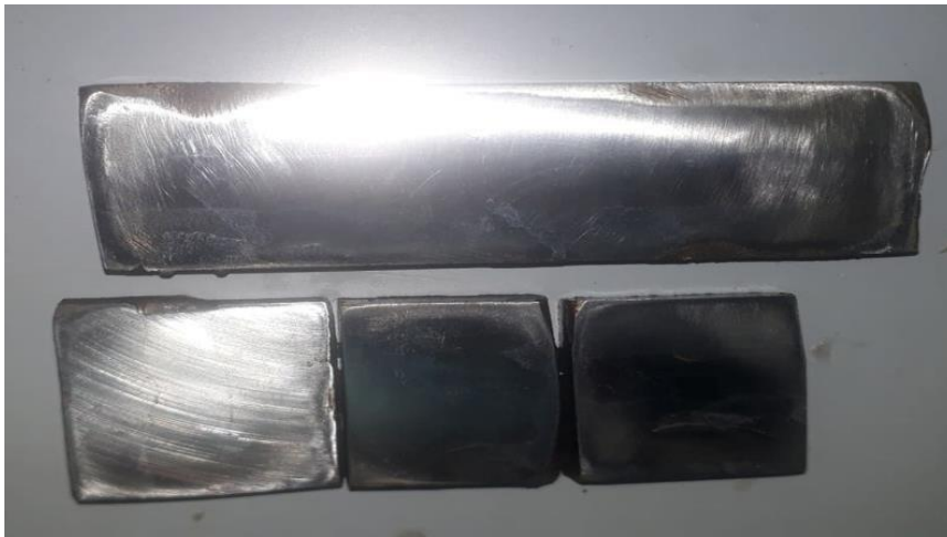
Figure IV.2 : Les surfaces des plaquettes soudées après le polissage.
