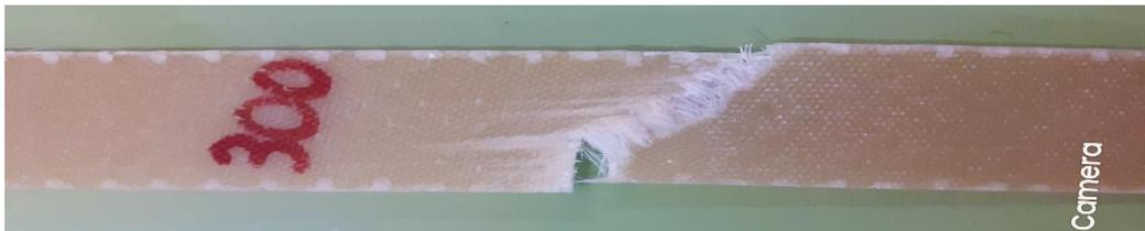
Figures3.40 : éprouvette verre sergé de traction
