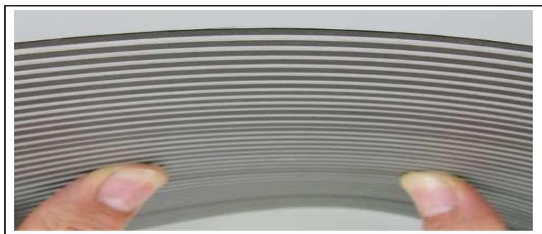
Figure 2.29 : Exemple de composite stratifié (fibres de verre et de carbone)
