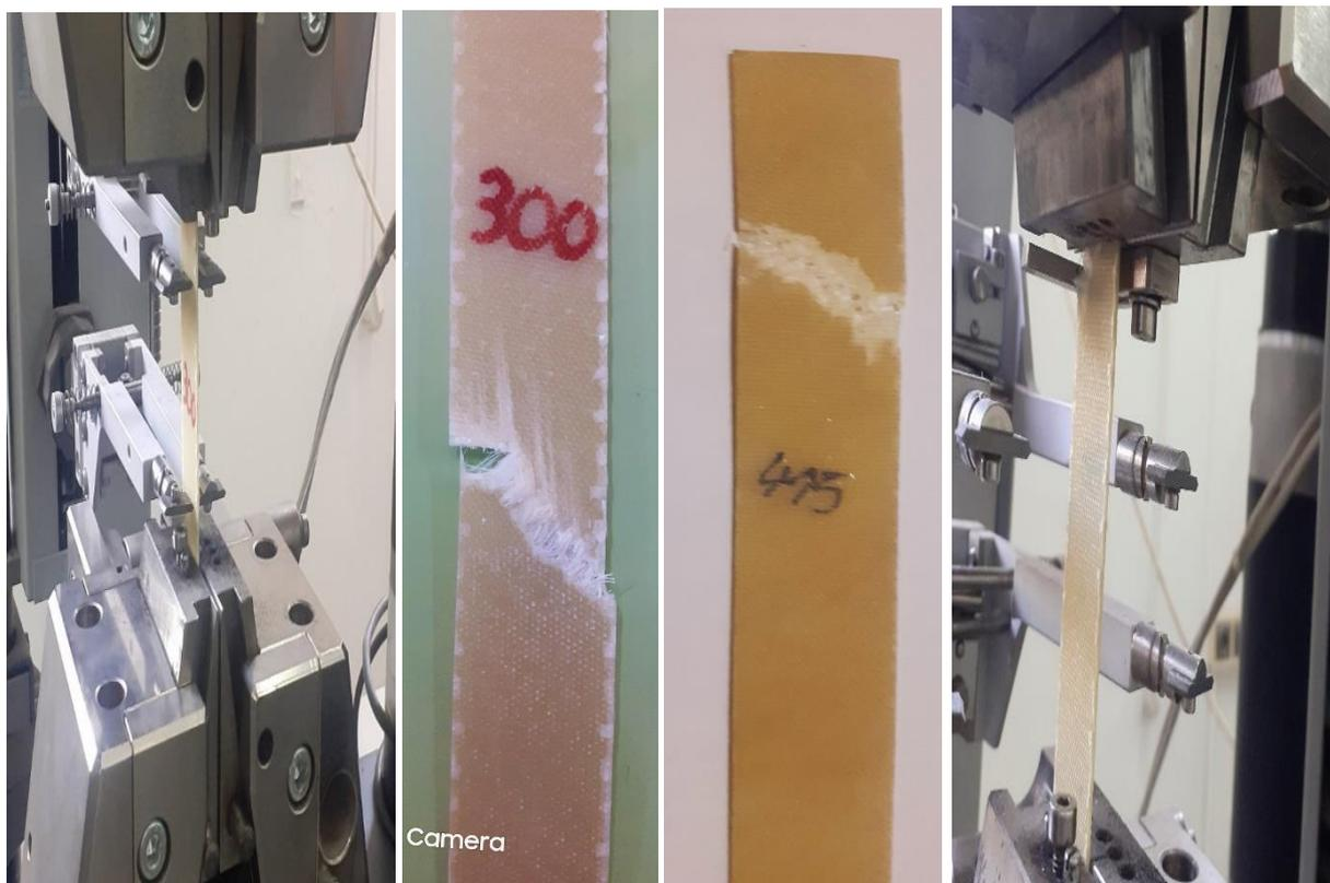
Figure 3.38 : Eprouvtes avant et après rupture
