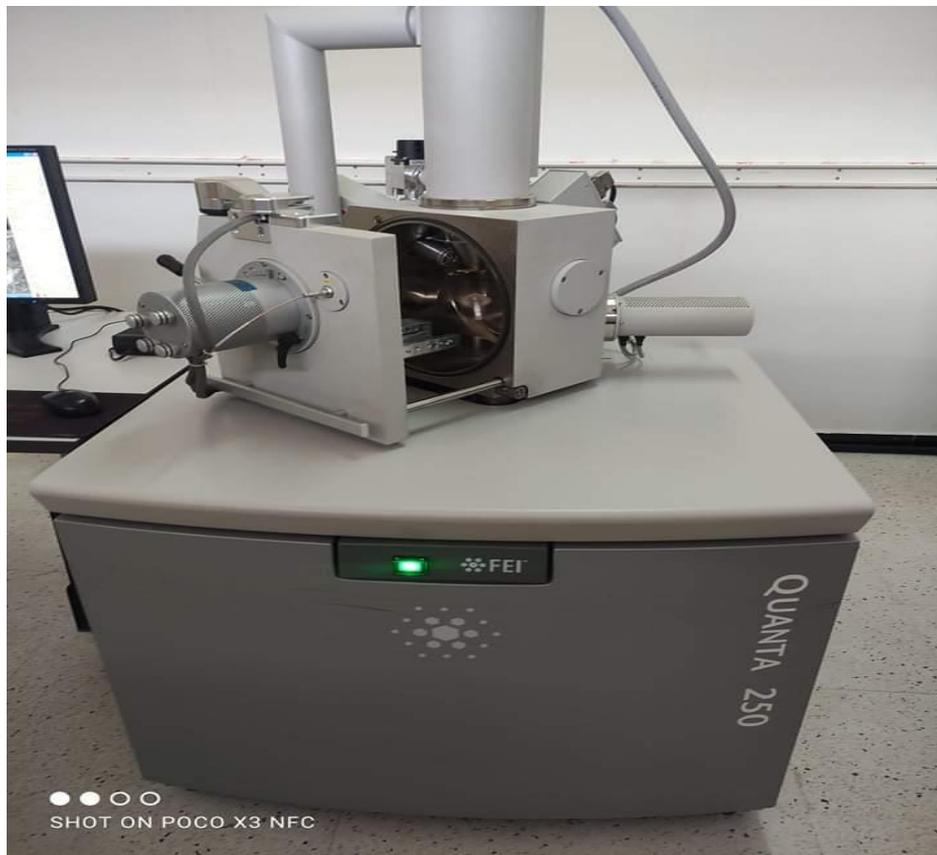
Figure 4.43: l'outil microscope électronique à balayage MEB
