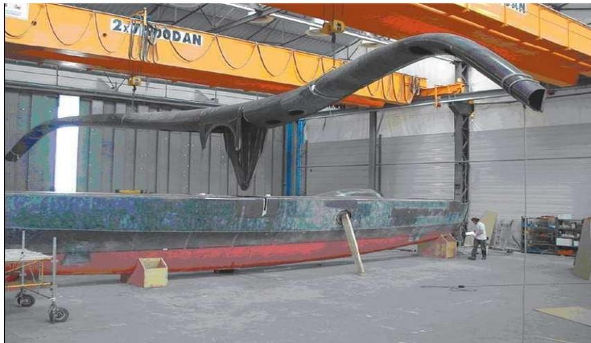
Figure 2.27: Assemblage d'un bras de multicoque océanique 60 pieds ORMA.
