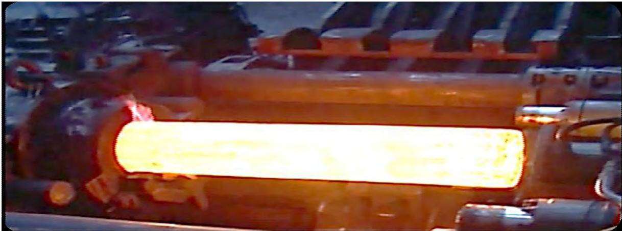
*Figure II.3 : presse à percer de (800-1200) tonnes*
