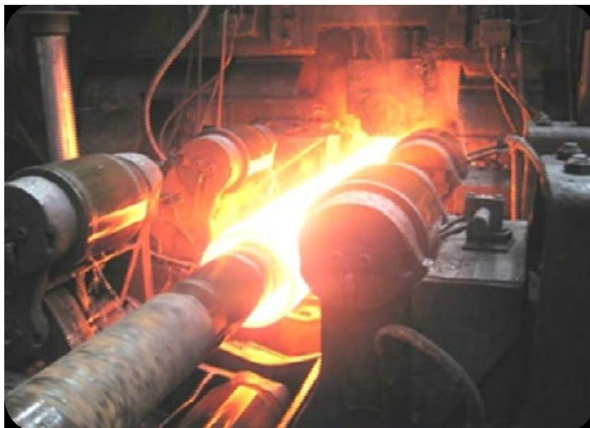
*Figure II.8 : Emprise de l'ébauche entre le mandrin de perçage et les cylindres obliques d'une part et les guides inférieur et supérieur d'autre part*
