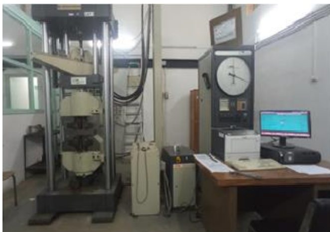
Machine de traction MFL PRUFSYSTEME UHP 600KN
