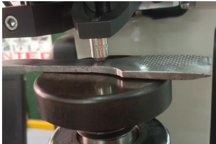
Figure IV-1 : démarrage de l'essai de dureté
