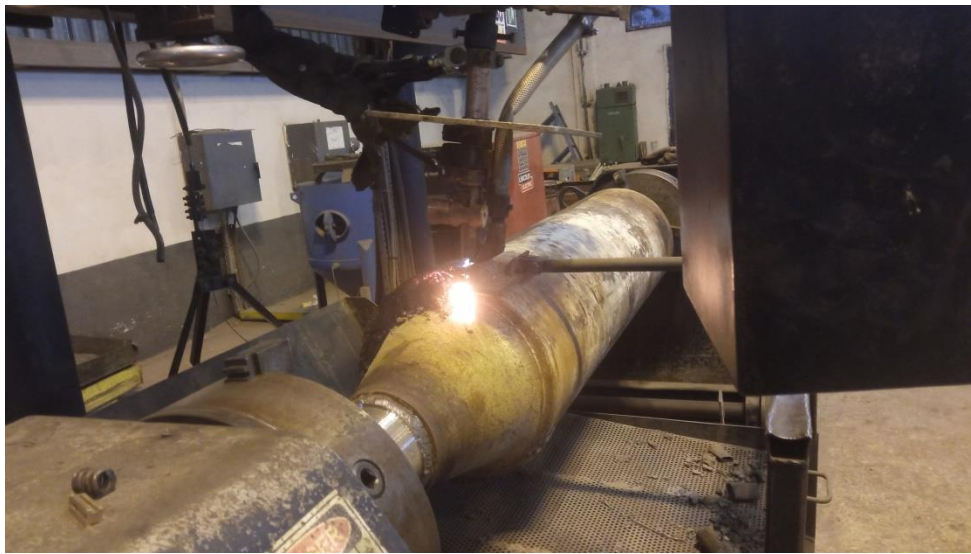
Figure II- 3 : rechargement a la machine
