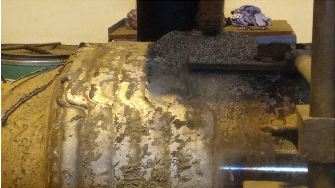
Figure III-14 : le rechargement avec fil tendre
