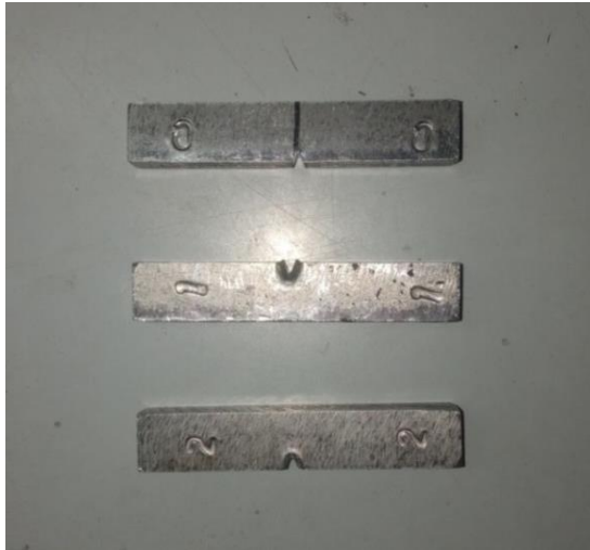
Figure IV-20: la forme des éprouvettes après usinage
