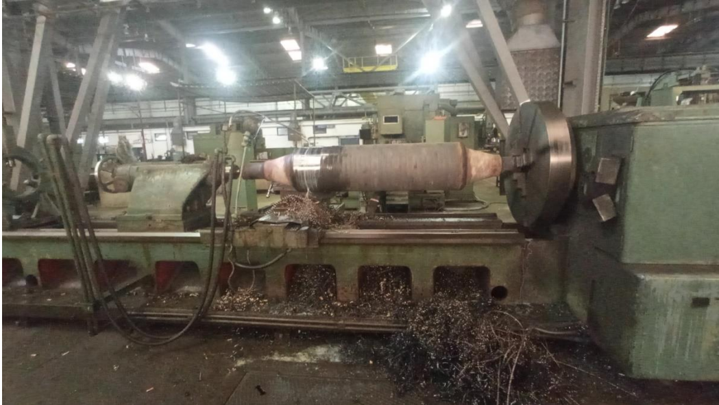
Figure III-21 : montage de rouleau sur tour
