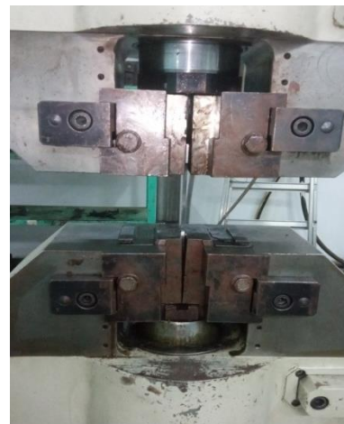
Montage de l'éprouvette entre les deux mors de la machine de traction
