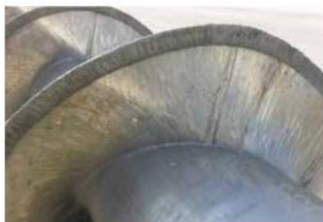
Figure I-6 : usure par corrosion
