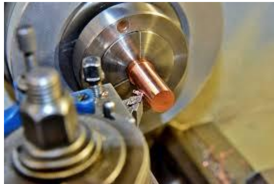
Figure I-13 : opération de décolletage
