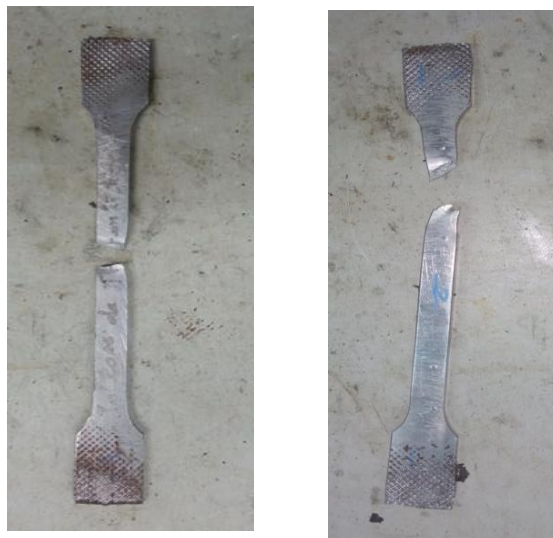
Figure IV-16: Les éprouvettes après la rupture
