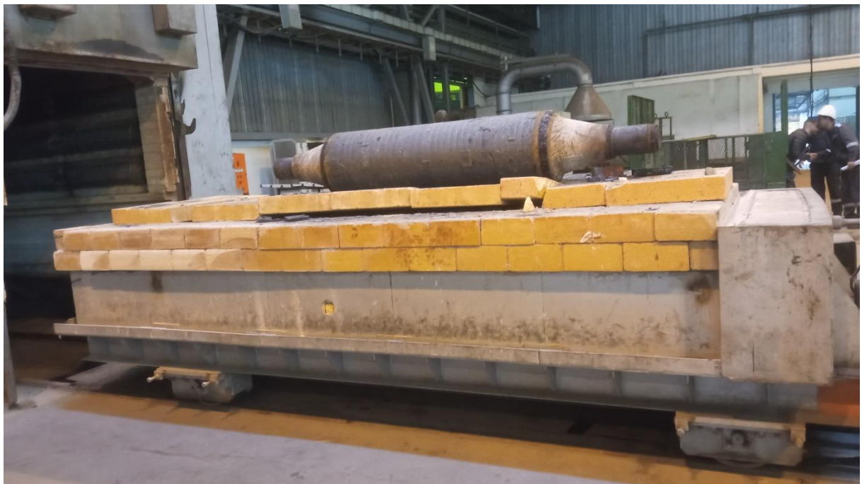
Figure III-18 : mettre le rouleau au four
