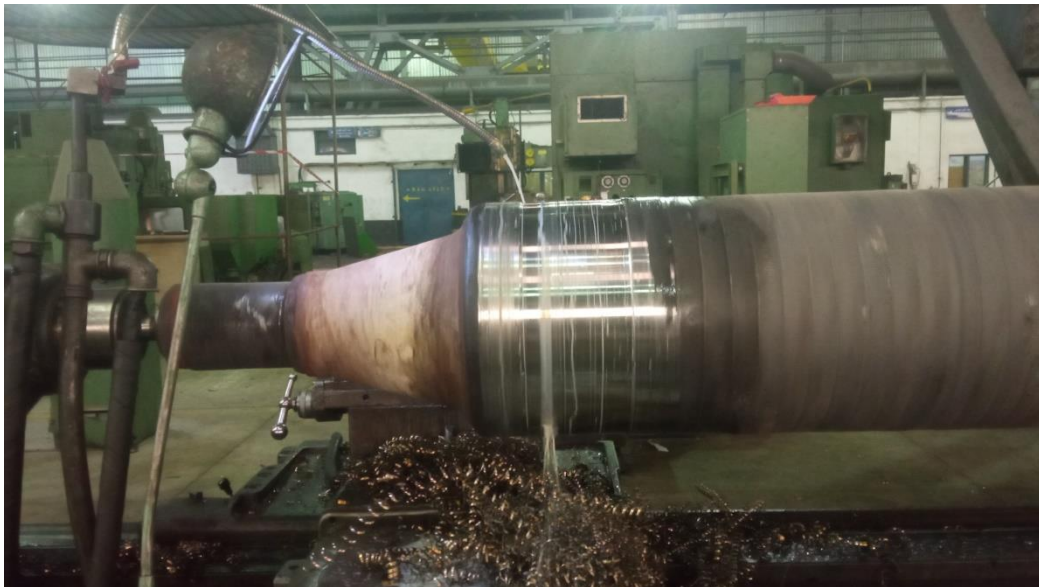
Figure III-22 : opération de chariotage
