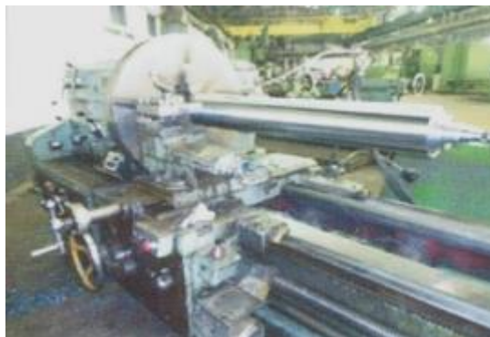
Figure III-6 : montage mixte sur le tour à commande numérique 1M65
