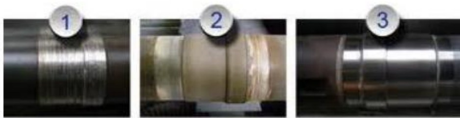
Figure II.1 : Rechargement d'une pièce usée
