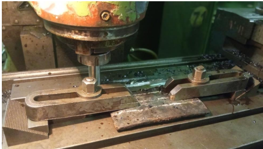
Figure IV-8 : l'opération de découpage
