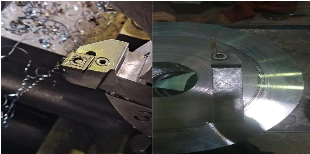
Figure III. 2 : outil à charioter et dresser/outil à tronçonner
