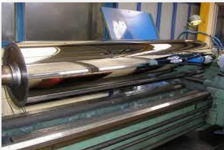
**Figure II.17** : Technique de superfinition pour obtenir une surface à très faible rugosité [24]
