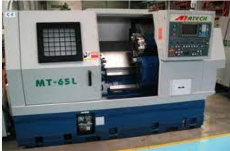
Figure I. 10 : Tour parallèle à charioter et à fileter à commande numérique [14]
