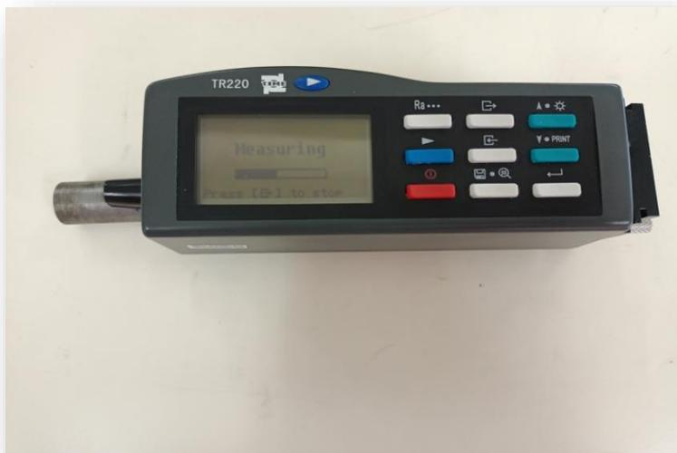
Figure II.15 : Mesure des états de surface
