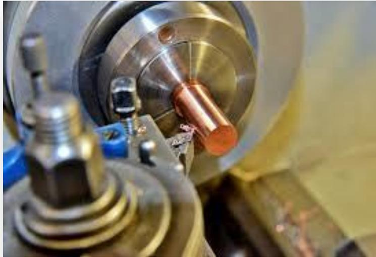
**Figure I.1 : Tournage mécanique [7]**
