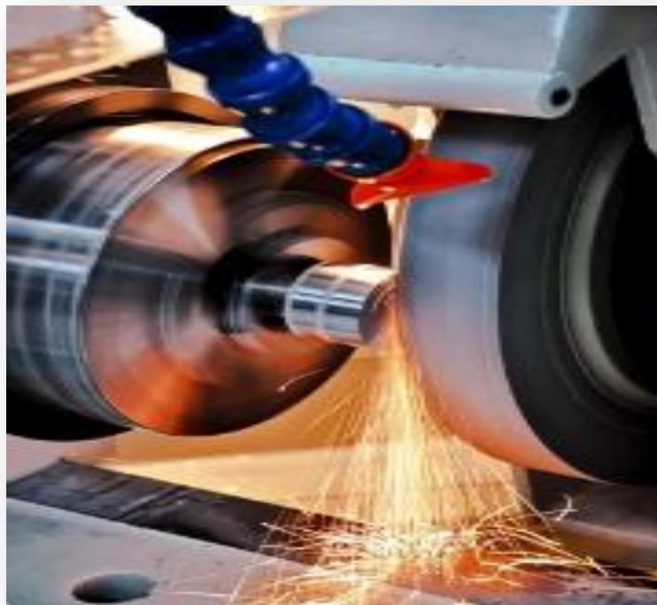
**Figure II.16 : Opération de rectification [23]**
