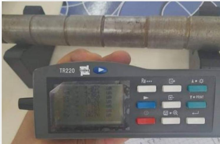
Figure II.14 : Rugosimètre
