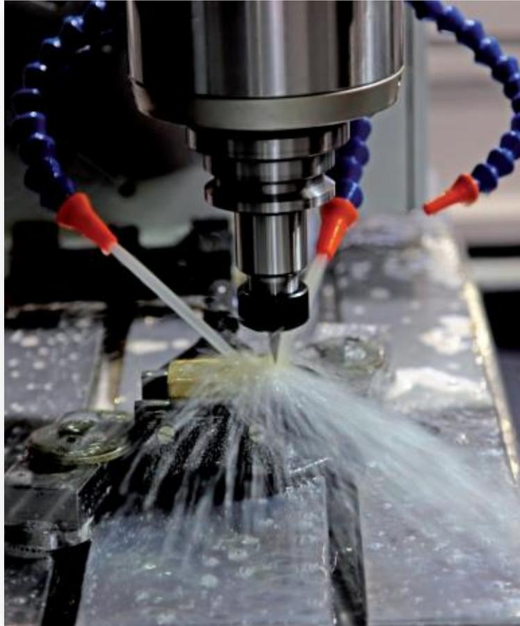
**Figure II.20** : Fluide d'usinage [32]
