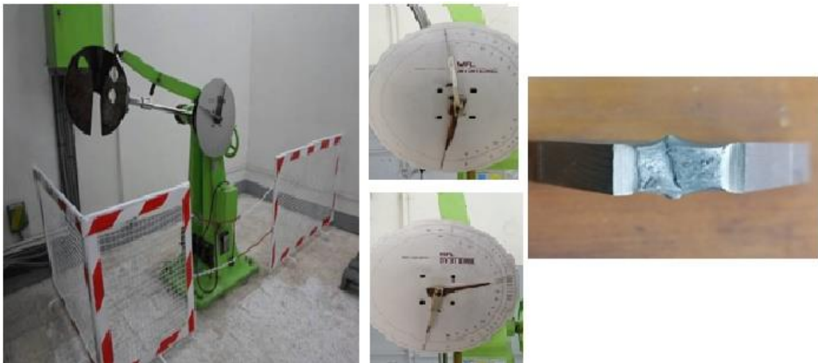
Figure III.23 : Mouton pendule -Charpy- position des aiguilles avant et après l'essai
