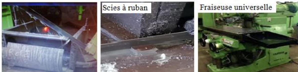
Figure III.8 : préparation des échantillons du matériau d'étude X52
