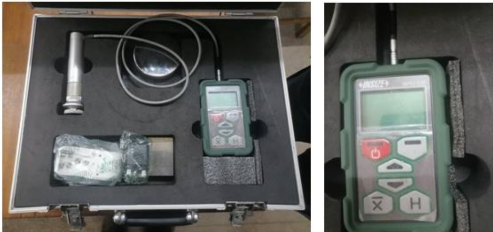
Figure III.24 : Duromètre de lecture directe des duretés de marque INSIZE ISHU-330
