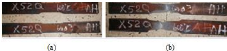
Figure III.22 : Eprouvette de nuance -X52 - avant (a) et après (b) essai de traction.
