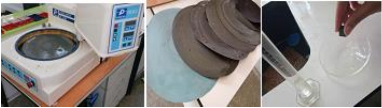
Figure III.18 : Opérations de préparation métallographique
