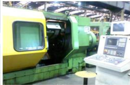
Figure III.6 : Fileteuse à CNC
