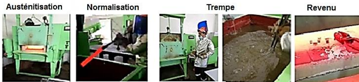
Figure III.17 : Opérations des traitements thermiques de l'acier HLE X52
