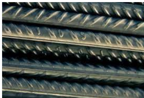
Figure I.10 : Aciers de ferrailage en barres [ https://aqs.dz/produits/rond-a-beton ]
