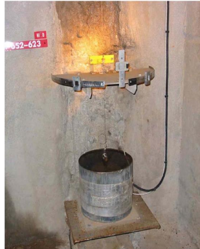
Figure 75 : Pendules : (a) directe et (b) inversé
