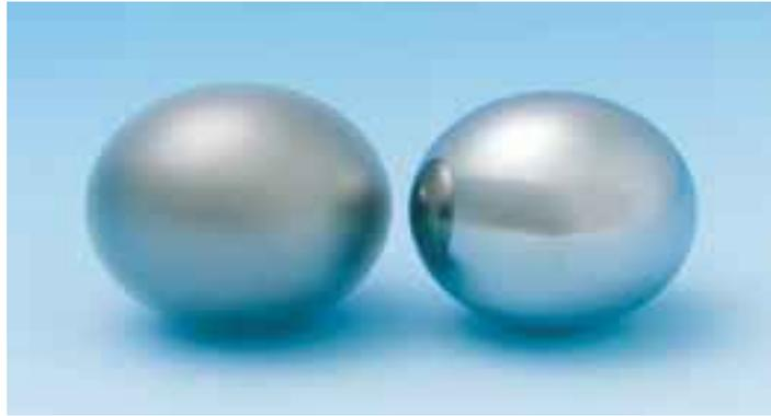
**Figure(60) : L'aspect mat de la surface de la bille signale la présence de micro cratères.**
