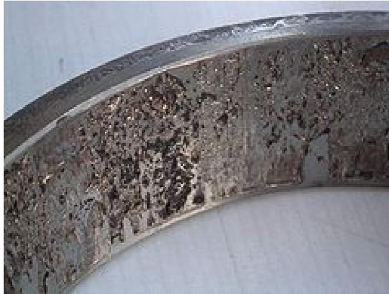
**Figure(33) : Phénomène de Fatigue du matériau des roulements.**
