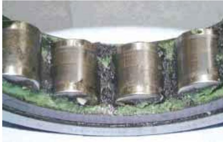
**Figure (62) : Graisse noircie par les décharges électriques à hautes fréquences.**
