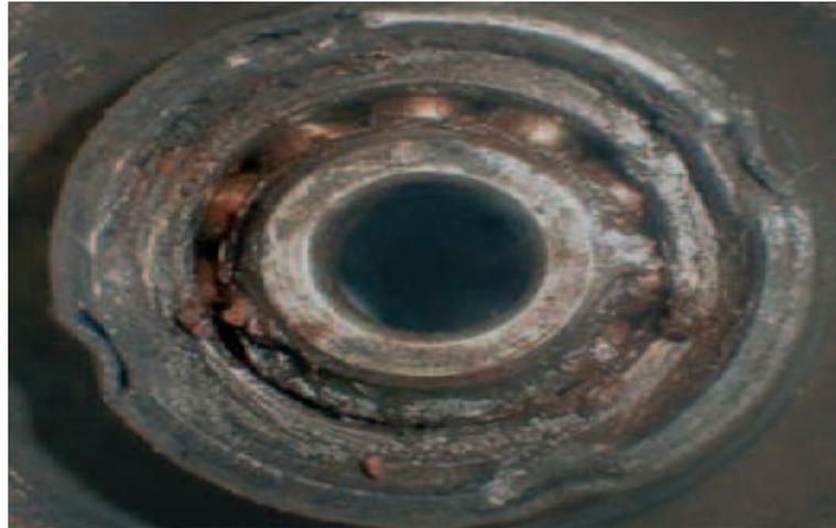
**Figure(35) : Phénomène de corrosion des roulements.**
