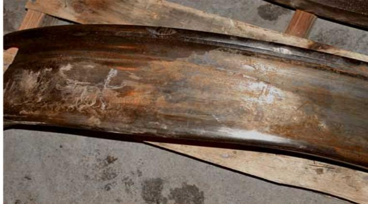
**Figure(36) : Phénomène de Déformation Plastique des roulements.**
