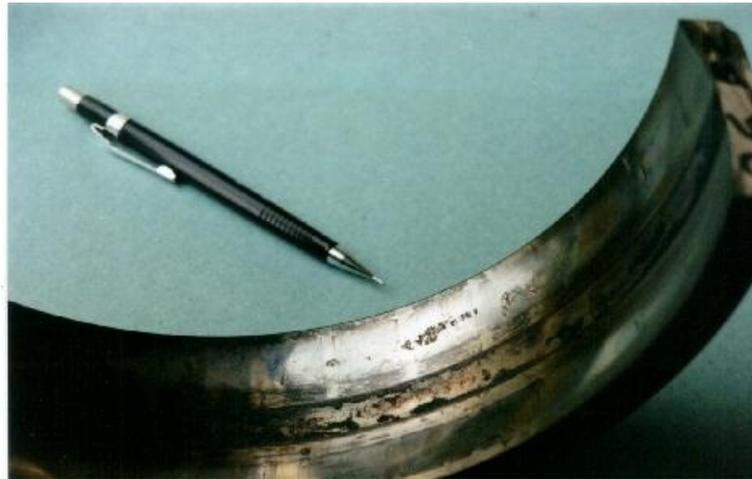
**Figure(34) : Phénomène d'usure des roulements.**
