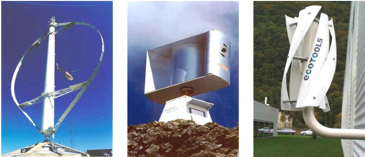
Fig.1.7. les aérogénérateurs à axe vertical.
