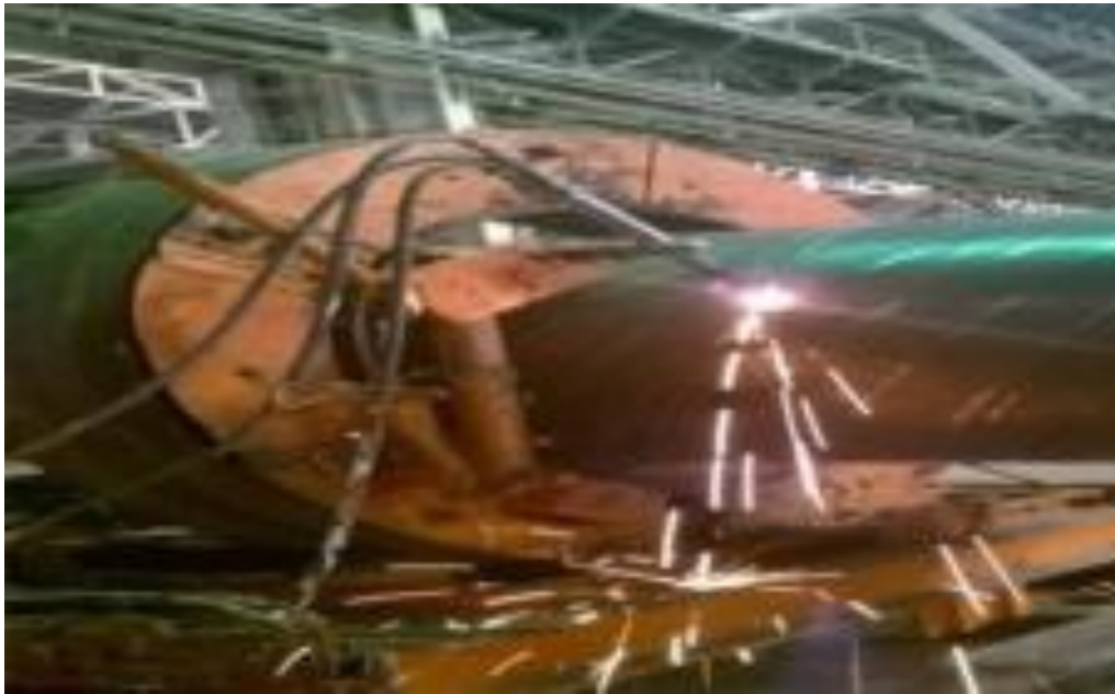
Figure I.6 : Tronçonneuse des tubes
