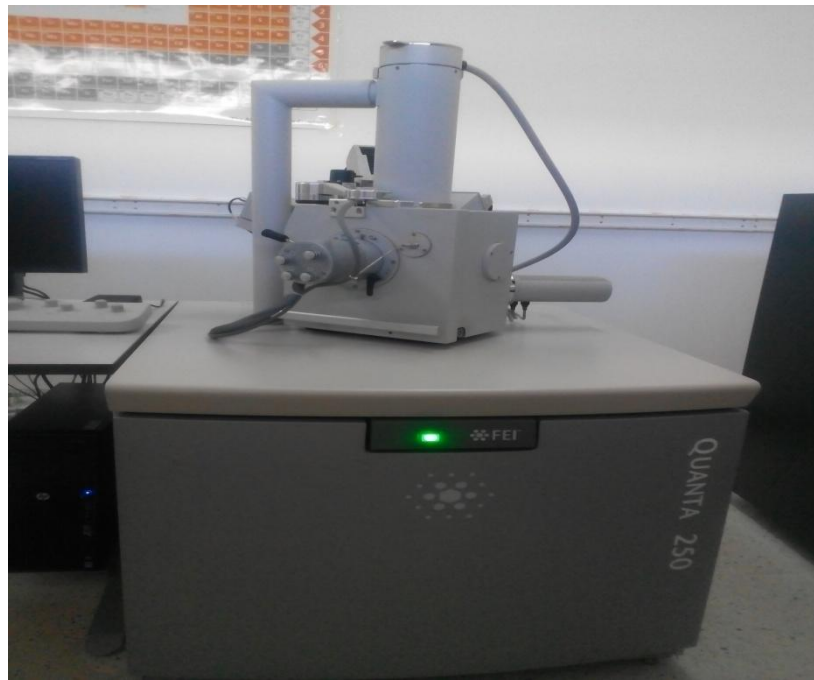
Figure IV.34 : microscope électronique à balayage (MEB) type QUANTA 250
