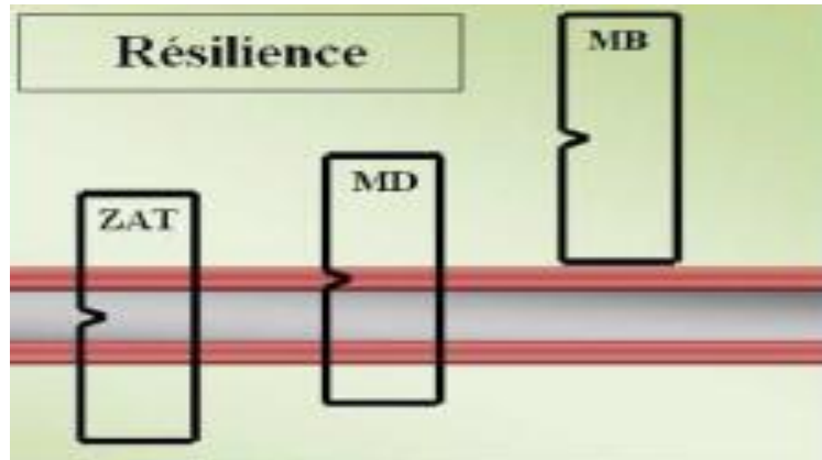
Figure IV.26 : méthode d'obtention des trois types d'éprouvettes de résilience
