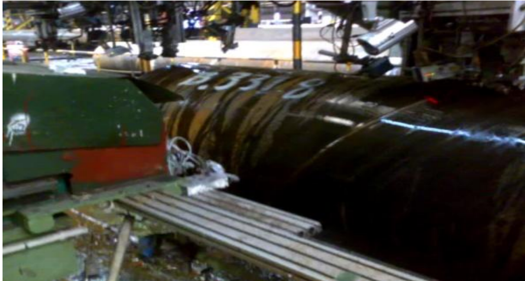
Figure I.10 : Contrôle par ultrasons
