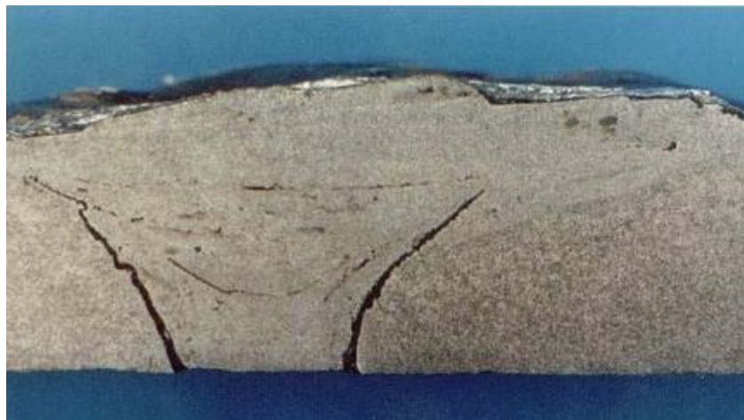
Figure III.8 : fissure à froid
