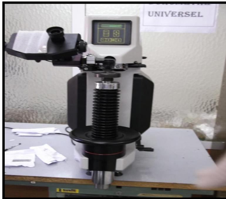
Figure. 4. :d'uromètre universel.
