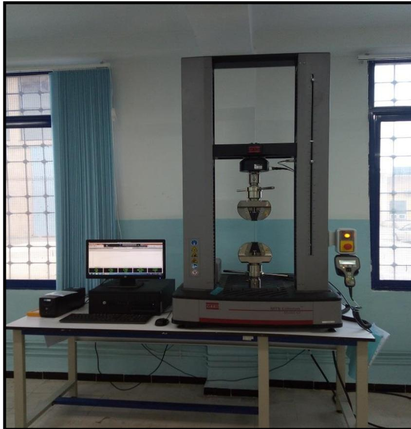
Figure. 5: Machine de traction « MTS »
