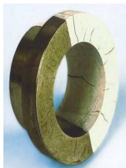
Figure II.12: Exemple d'une pièce avant (à gauche) et après (à droite) le contrôle par ressuage.
