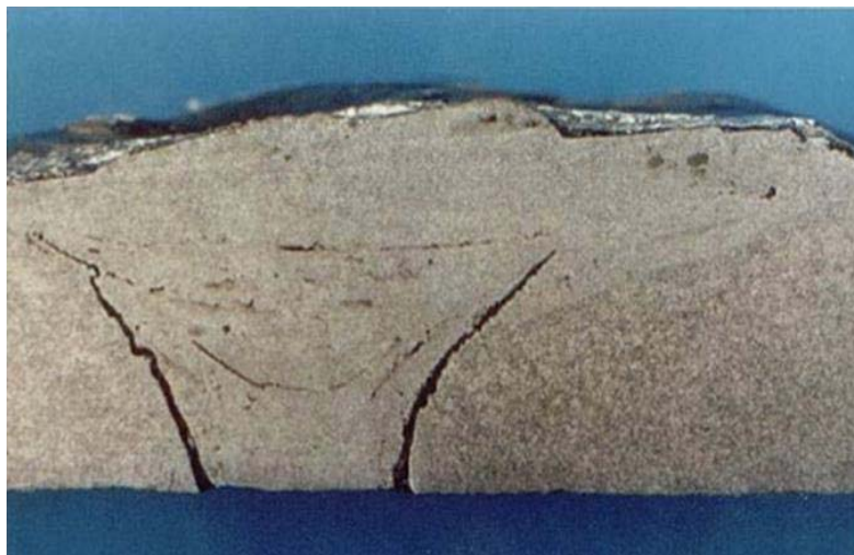
Figure II.7: Fissure à froid (6) .
