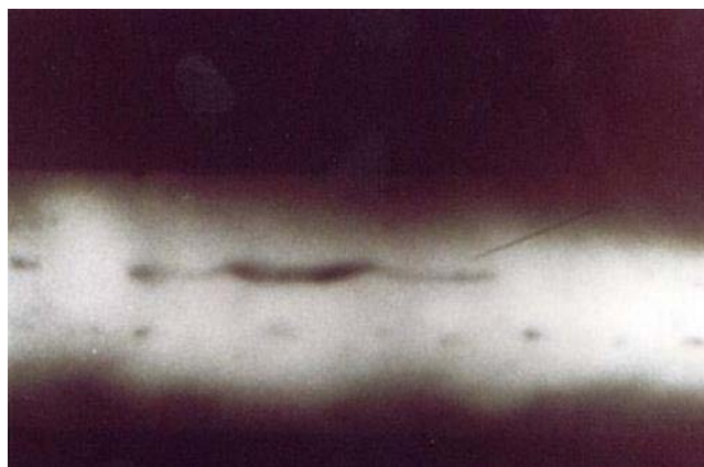
Figure II.8: Inclusion de laitier décelé par radiographie (6) .
