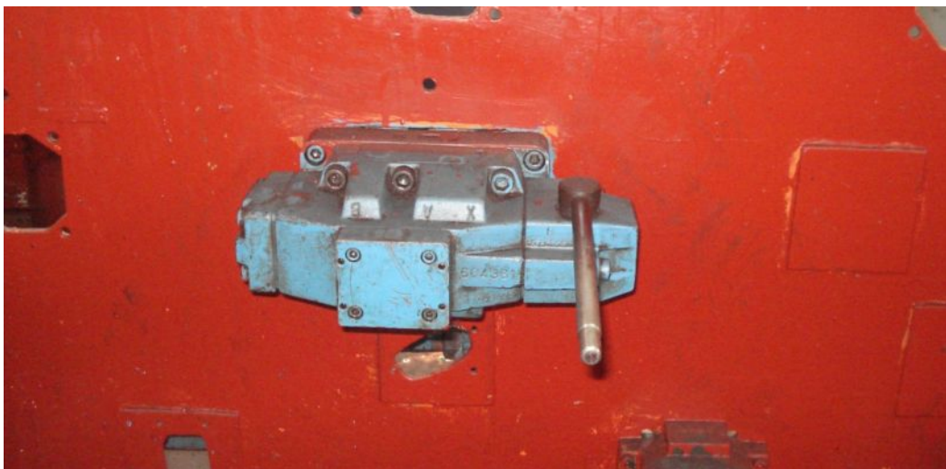
Figure 1.15- Distributeur 4/2 manuel du banc d'essai
