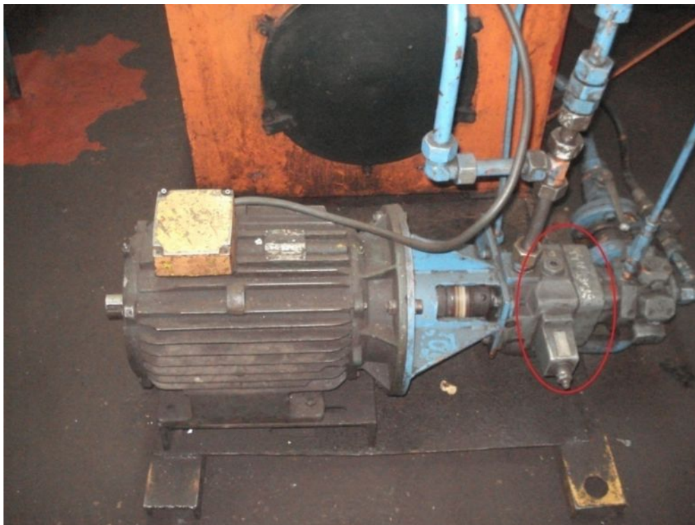
Figure 1.6-Pompe à palettes du banc d'essai
