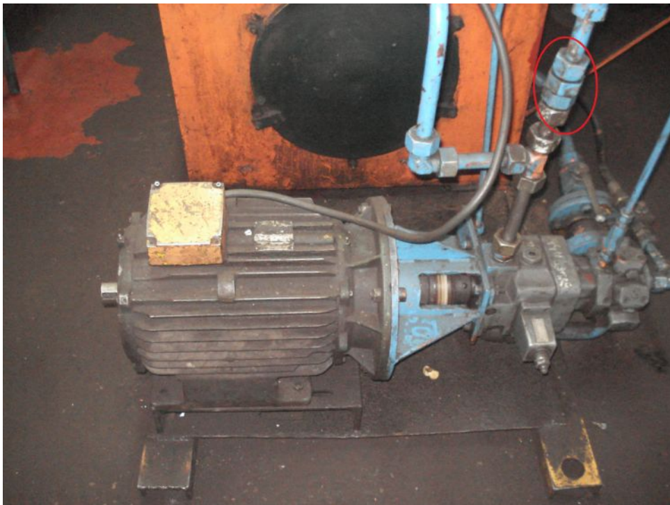
Figure 1.13-Clapet anti-retour du banc d'essai
