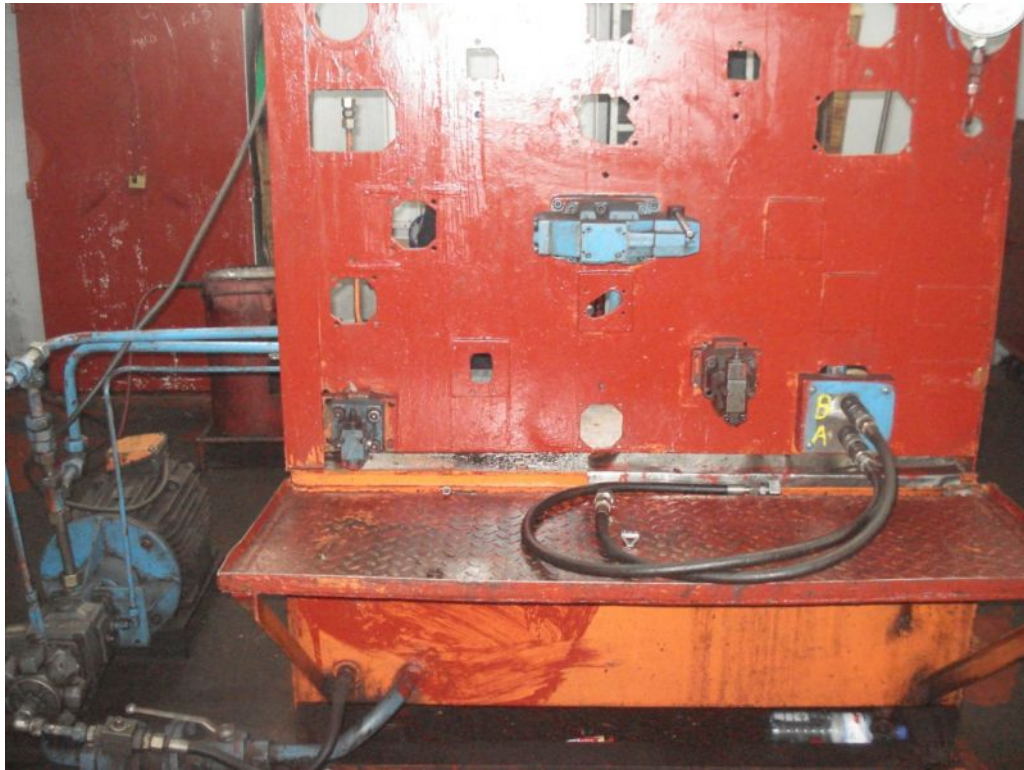
Figure 1.1-La table de travail, les sorties A et B et les limiteurs de pression
