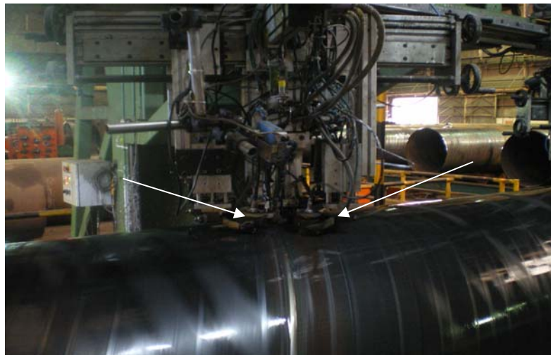
Figure III.17: Photographie de l'ensemble mécanique supportant les palpeurs.
