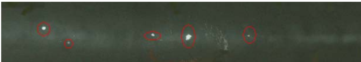
Figure III.21: illustration d'un défaut de soufflure dans un cordon de soudure.
